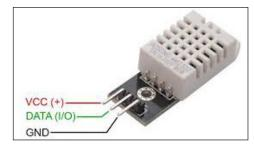
Fig. 2: DHT22 Temperature Sensor
